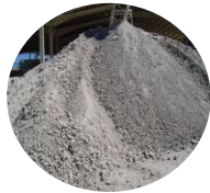
Finos reciclados de residuos de concreto y construcción
